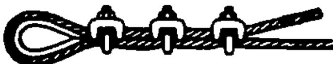
Método Incorrecto = Pernos en extremo bajo tensión del cable (Esto enredará los hilos en el extremo bajo tensión).
