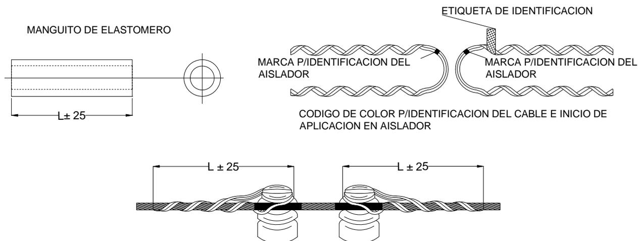
**TABLA I (Malla pref. de amarre cima lateral doble para aislador de 13.2 KV D = 60 mm)**
